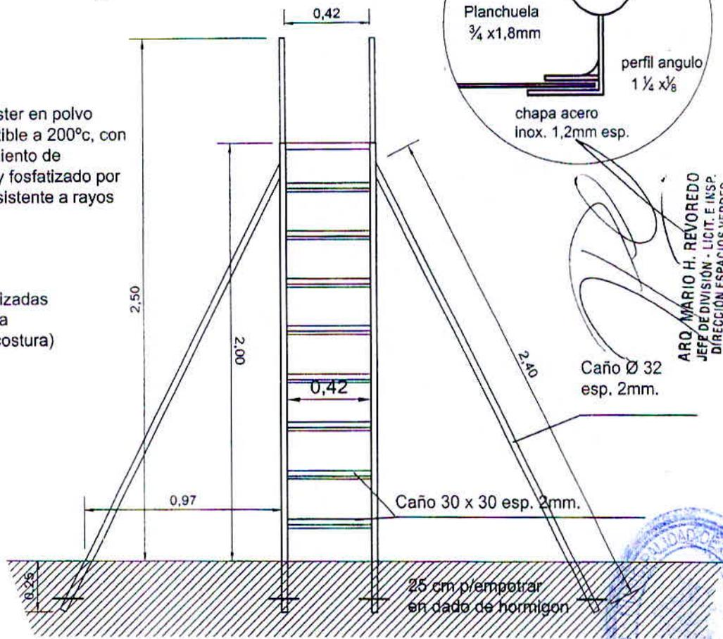
Pintura poliester en polvo termoconvertible a 200°C, con previo tratamiento de desengrase y fosfatizado por inmersión resistente a rayos UV.
