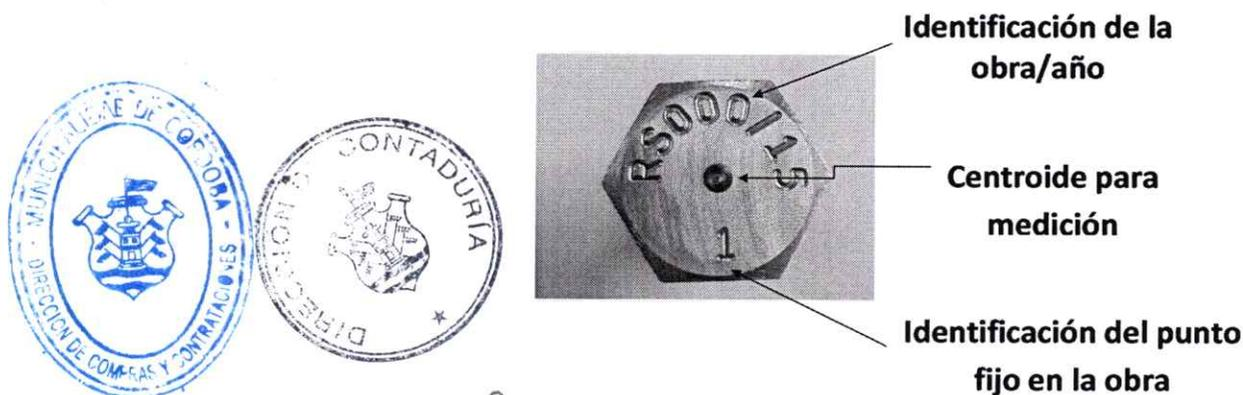
**Estos puntos fijos conformaran la red Municipal de referencia altimétrica para obras de infraestructura y cuyos nodos serán identificados mediante datos monográficos de ubicación e identificación.**
