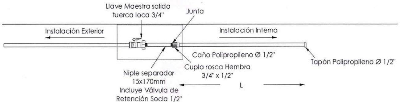
L: longitud de chicote a determinar por la inspección de obra. (L ≤ 1 m)
