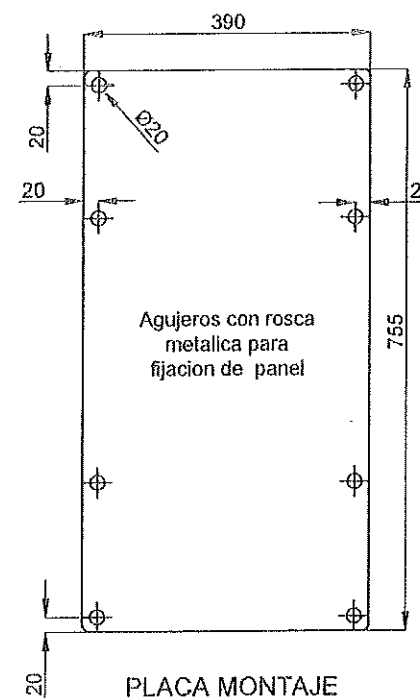
VISTA POSTERIOR (Ubicación de agujeros para instalar abrazadera)
