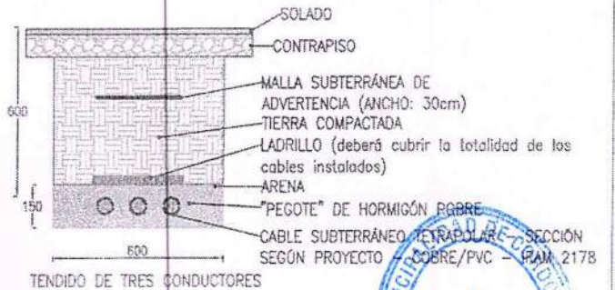
TENDIDO DE TRES CONDUCTORES
