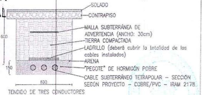
NOTA: SE DEBERÁN REALIZAR "PEGOTES" DE HORMIGÓN POBRE SOBRE EL CONDUCTOR EN LOS SECTORES DE ACOMETIDA A LAS COLUMNAS.
